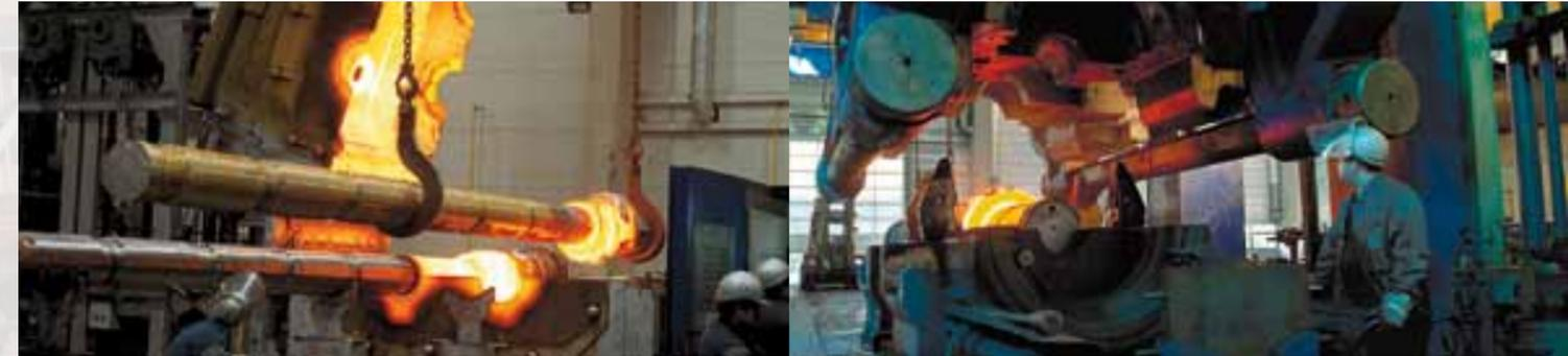
Kurbelwellenrohlinge ab ca. 4,5 bis 9 m Länge werden in hydraulischen Pressen und im Einzelhubverfahren produziert. Hier müssen extrem hohe Umformkräfte beherrscht werden. Für die Hub-für-Hub-Schmiedung werden die Roh-teile (Spindeln) abschnittsweise auf bis zu 1300°C erhitzt. Dann erfolgt das axiale Stauchen der Spindelabschnitte und das vertikale Pressen der einzelnen Pleuellagerzapfen. So entsteht Schritt für Schritt die
