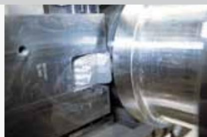
Durch das gezielte Einbringen von Druckeigenspannungen, das Schlagverfestigen, können wir die Dauerfestigkeit steigern.
