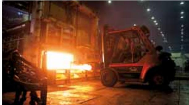
In Kammeröfen werden die Rohteile auf bis zu 1300 °C erhitzt und anschließend zu den Schmiedehämmern transportiert.
