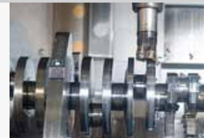
Im CNC-Drehfräszentrum entsteht aus Rundstahl eine für das Härten und Schleifen vorbereitete Kurbelwelle.
