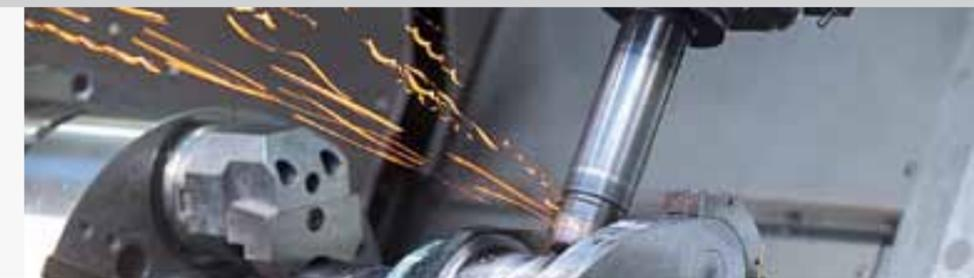
Nur hochfeste Werkzeuge ermöglichen das Drehfräsen von Pleuellagerzapfen, die bereits gehärtet wurden.
