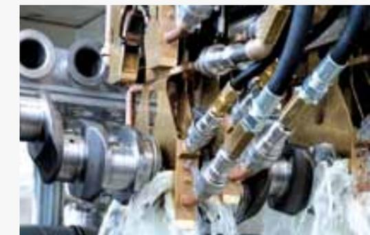
Die Oberflächenbehandlung ist auch im Geschäftsbereich AUTOMOTIVE eine der grundlegenden Fertigkeiten. Exzellentes Ingenieurwissen wird ergänzt durch jahrzehntelange Erfahrungen beim Induktionshärten. Daraus entstand im Jahr 1952 unser Produkt Härtemaschinen. Dieses Produkt ist weltweit über 500 Mal bei Motorenherstellern im Einsatz. Durch Induktionshärten lassen sich Kurbelwellen gezielt auch in den hoch beanspruchten Radialbereichen härten.
