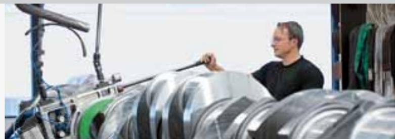
Das hochpräzise Schmirlgeln der Lagerflächen und Radian erfolgt bei Kurbelwellen ab ca. 5 m Länge überwiegend manuell und setzt viel Erfahrung voraus.
