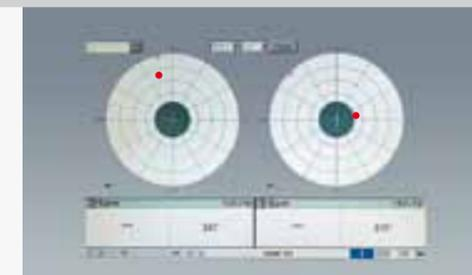
Der Bildschirm der Wuchtmaschine zeigt Winkellage, Durchmesser und Tiefe der notwendigen Ausgleichsbohrungen. Diese können direkt auf der Wuchtanlage eingebracht werden.
