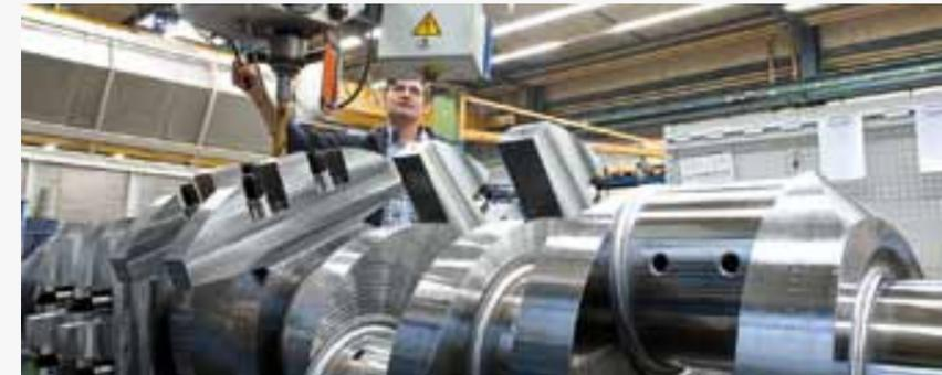
Innovative Fertigungstechnik und viel Erfahrung beim dynamischen Wuchten sorgen für den schwingungsarmen Lauf der Großkurbelwelle im Motor.
