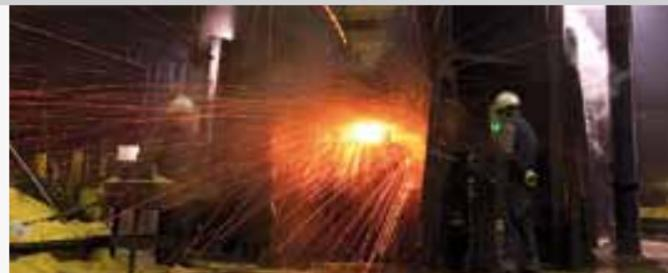
Der Schmiedeprozess umfasst mehrere „Hitzen“ und Schmiedungen, bis aus dem Knüppel das Schmiederohteil mit der gewünschten Kontur entstanden ist.
