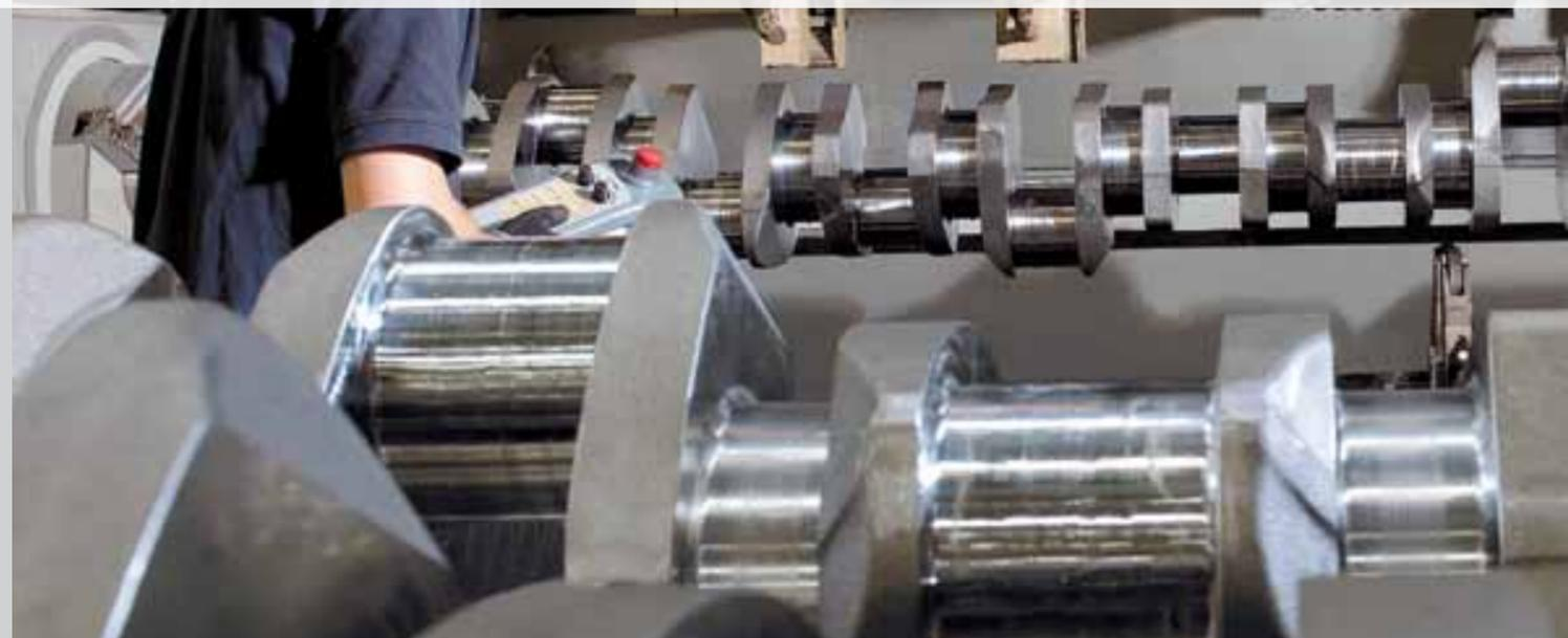
Das Härten der Großkurbelwellen ist nahtlos in die Fertigungslinie integriert. Der Arbeitsplatz besteht aus Waschmaschine, Induktionshärtemaschine, Rissprüfanlage und Anlassofen.
