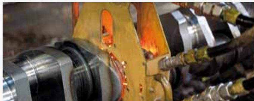
Einer der Prozessschritte für höhere Dauerfestigkeit ist das Induktionshärten der Lagerzapfenradien. Der Induktor erwärmt einen Pleuellagerzapfen, danach wird diese Lagerzapfenstelle durch Abbrausen mit Kühlflüssigkeit abgeschreckt.
