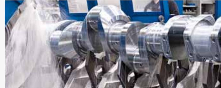
Quantensprung: Auch Großkurbelwellen werden bei uns mit modernsten CNC-Pendelhub-Schleifmaschinen geschliffen.
