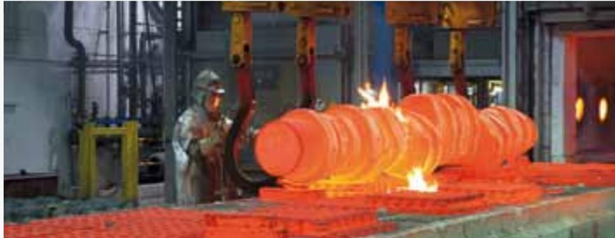
Neben dem eigentlichen Schmiedevorgang ist das anschließende Vergüten und Entspannen der Kurbelwellenrohnteile für die Qualität entscheidend. Für das Vergüten werden die Rohlinge in Herdwagenöfen erwärmt. Die Temperatur muss dazu oberhalb der Grenze zur Gefügemwandlung liegen. Dann werden die Rohlinge in Öl- oder Wasserbädern abgeschreckt und damit gehärtet. Abschließend werden sie bei geringerer Temperatur angelassen und langsam abgekühlt, um dem Stahl die erforderliche
