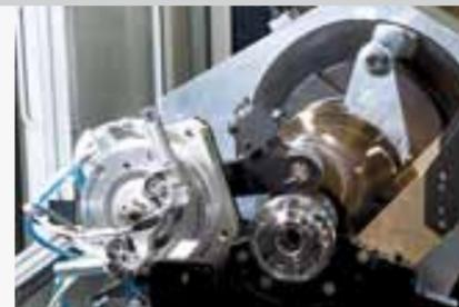
**Vollautomatische, dynamische Wuchtmaschinen werden maschinell be- und entladen.**
