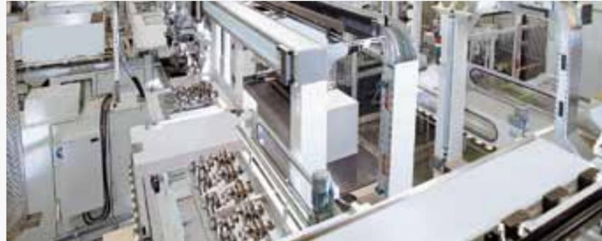
**Durchgehende Fertigungslinien: Die CNC-Bearbeitungszentren zum Schleifen von Haupt- und Pleuellagerzapfen in Serie sind mit Portalladern verkettet.**
