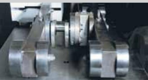
Die Biegedauerfestigkeit von Pkw-Kurbelwellen wird an einem Biegeprüfstand getestet.
