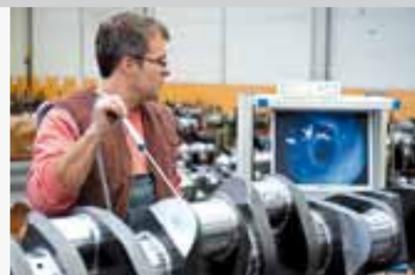
Videoendoskope ermöglichen es, auch die unzugänglichsten Bohrungsverschneidungen auf Grاتفreiheit zu überprüfen.
