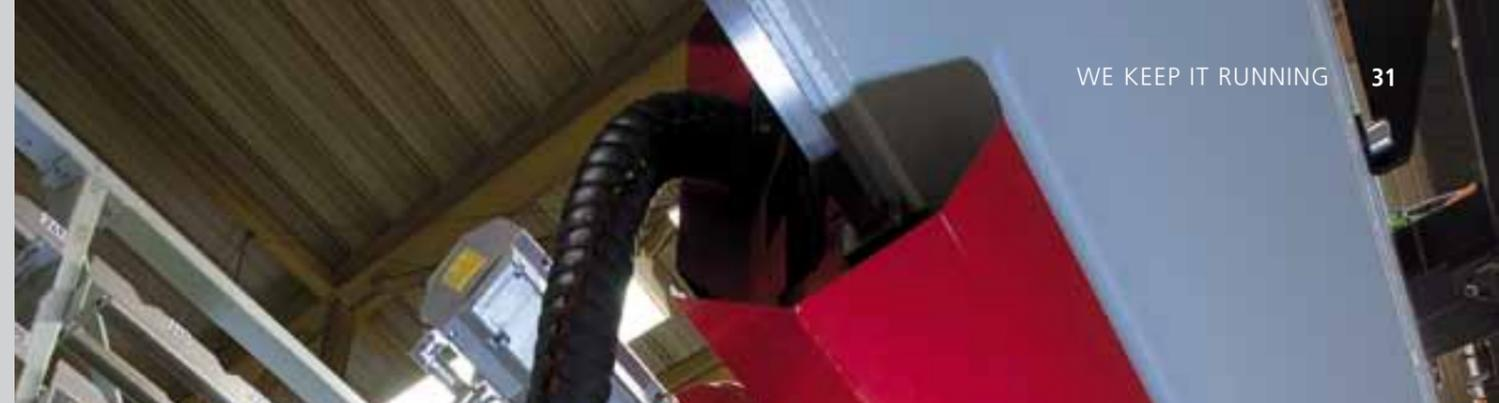
Als Partner der Automobilindustrie bieten wir einen hohen Automatisierungsgrad für die möglichst effiziente Fertigung. Das Bild zeigt ein robotergesteuertes Zwischenlager zur Abkühlung von vorbearbeiteten Kurbelwellen.
