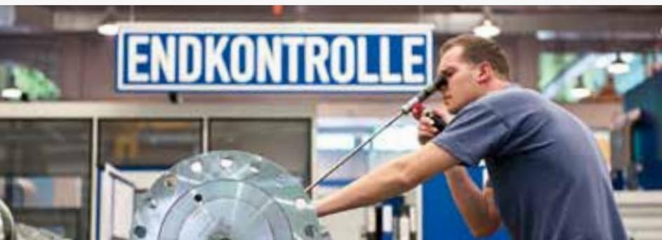
Bis zum fertigen Produkt sind auch manuelle Arbeitsschritte erforderlich. Hier werden die Ölkanäle mit einem optischen Endoskop auf Grاتفreiheit untersucht.
