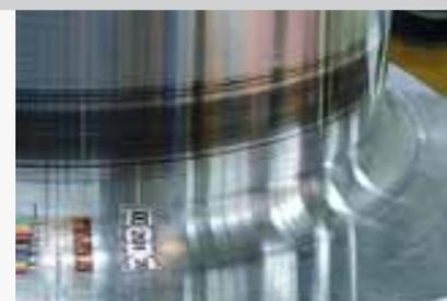
Mit Dehnungsmessstreifen in den Übergangsradien zur Pleuellagerwange können die Biegespannungen analysiert werden.
