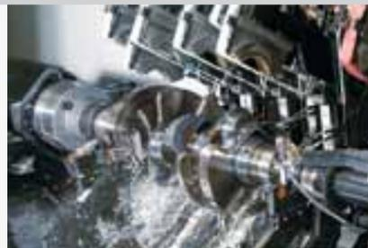
**Mit automatischen Bandfinish-Maschinen erzielen wir die geforderten Oberflächenrauigkeiten und Formtoleranzen.**
