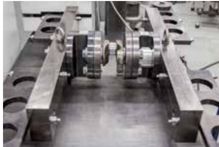
einaxiale sowie biaxiale Dauerfestigkeitsprüfung
