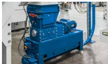
Späneabsaugstation mit Zerkleinerer
