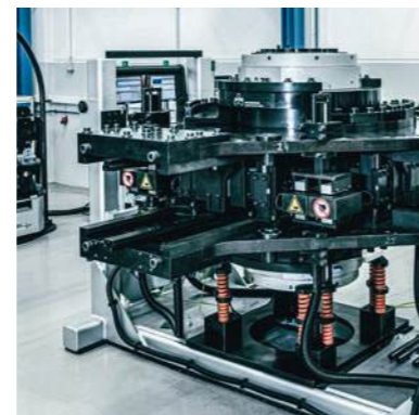
EINAXIALE SOWIE BIAXIALE DAUERFESTIGKEITSPRÜFUNG
