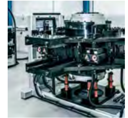
EINAXIALE SOWIE BIAXIALE DAUERFESTIGKEITSPRÜFUNG
