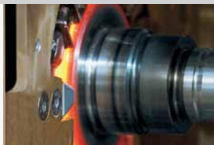
Optimierung der Härteprozesse von Prototypen auf unserer Labormaschine.
