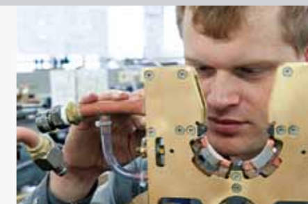
Endmontage und Feinjustage eines Induktors.
