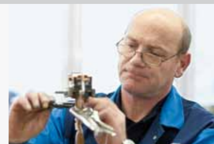
Zusammenbau der filigranen Bauteile zum Heizleiter.
